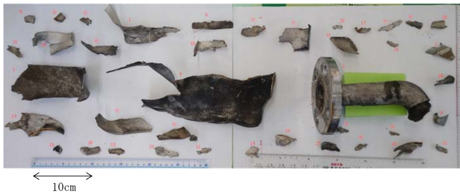
【図 8. 破裂した配管の破片】
