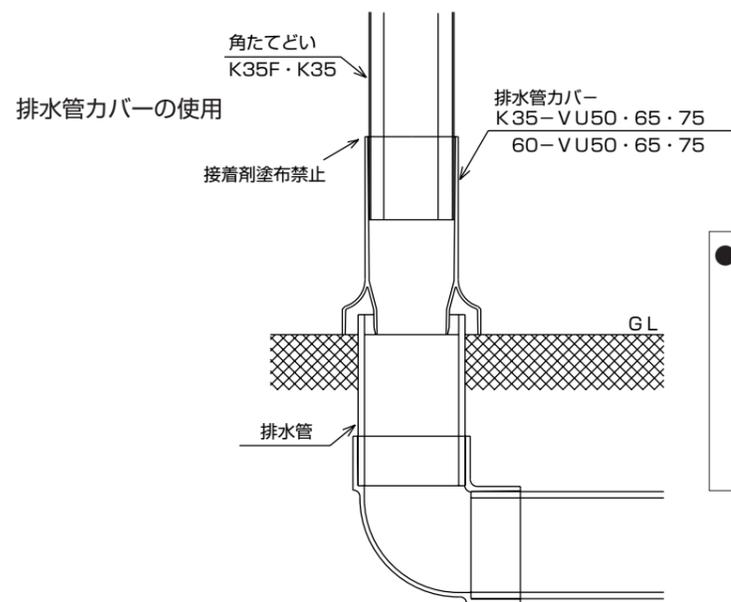
●排水管カバーはたてどいの伸縮をスムーズに吸収します。排水管カバーのご使用をおすすめします。又排水管の掃除も排水管カバーを取り外し簡単に行なえます。
