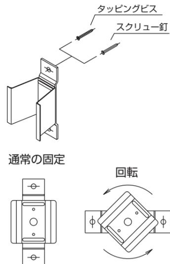
※下地材により金具を横向きで固定する場合は、取付部を回転させてたてどいを取り付けます。
