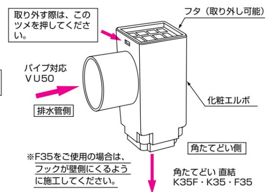
①たてどいと壁との隙間Aをはかり隙間が60mm以下の場合には、化粧エルボの目安線に沿って化粧エルボを切断してください。
