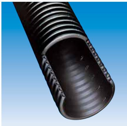
**小さな粗度係数。**—トヨドレンダブル管は内面平滑のため、流量抵抗が小さく、流れは非常にスムーズ。塩ビ管とほぼ同等の粗度係数となっています。(粗度係数:n=0.010)
