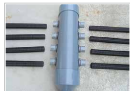
① 滑剤を塗り、DV用ソケットを挿入。
