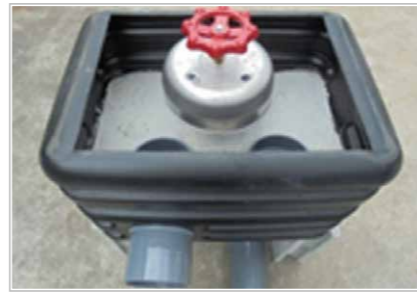
⑥ 市販の給水バルブを取る付ける。
