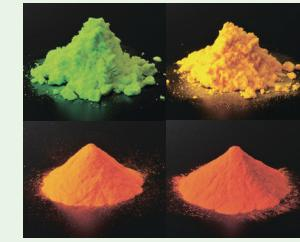
アロンブライト蛍光体は当社が長年培ったセラミックス技術をベースに製造されています。緑色から赤色まで豊富な色が選択可能で、液晶ディスプレイ用バックライトや照明用のLEDに使用することで、従来より高輝度化、高信頼性化が実現できるだけでなく、より鮮やかな光を表現することができます。
