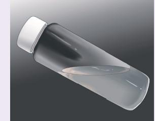
電気特性(低誘電率・低誘電正接)・低吸湿性・高耐熱性に優れた新規樹脂材料。軟質でありながら架橋性を有し、他熱硬化系樹脂との配合により容易に硬度調整が可能、また銅箔との密着性にも優れることから、高周波回路基板や各種層間絶縁材向けとして使用可能です。
