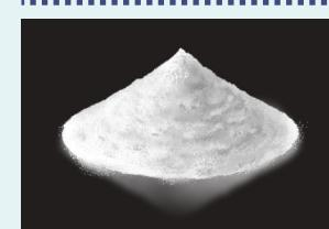
耐熱性、耐食性、耐摩耗性に優れる非酸化物系セラミックスの原料粉末です。自動車エンジン部品、エレクトロニクス部品、産業機械部品、各種複合材料などに可能性を秘めた材料です。
