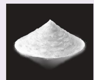
電気特性に優れたセラミックスの粉末です。5G通信機器等に使用されるリジット基板への適用を想定しています。従来の溶融シリカと同様な作業性でご使用が可能で、低誘電正接化が期待されます。なお粒径はサブミクロン～5ミクロンをラインナップしています。
