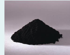
デンカブラックはアセチレンの熱分解により製造されるカーボンブラックです。その傑出した純度、伝導性(電気伝導性・熱伝導性)を利用して、ケーブルをはじめ、シリコーン製品、IC包装材などの分野で導電や静電気防止にその特性が生かされています。
