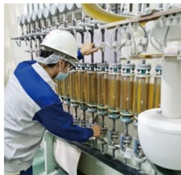
ガス流量計付近に取り付けたAI画像分析カメラからデータを取得し、制御室のモニターで計測値を確認。分析結果を基に、現場で流量計のバルブ調整を行う。
