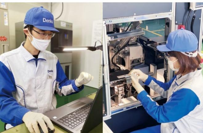
サンプルの目視確認(左)や、試験機でセラミックス基板を撮影(右)することで、AIに学習させるための画像データを選定・収集する。
