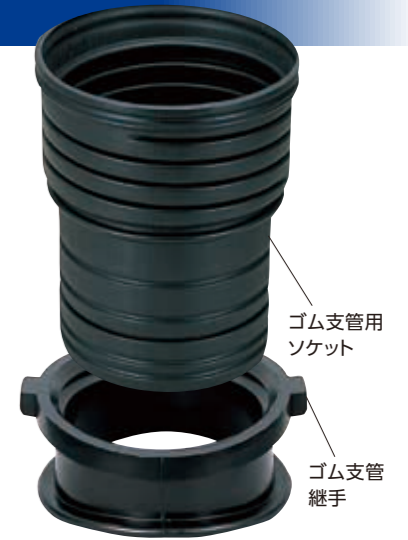
※200GSをクロス状に対面2ヶ所に取り付ける際は、管路流れ方向に対するその間隔を500mm以上は離れるようにしてください。 ※ゴム支管用ソケットφ75(100GS)、φ100(100GS)と枝管との接続に際しては、各枝管規格のリングをご使用ください。その他の管については、リングを使用しなくても接続できますが、接続部からの漏水は各管の有孔管用ソケットと同程度です。
