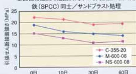
高温耐湿試験 60°C湿度90%環境下暴露試験 暴露後常温23°C湿度50%下1時間放置の後測定 鉄 (SPCC) 同士/サンドブラスト処理
