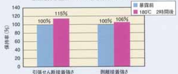
C-356-08のボンデ鋼板 (電気亜鉛メッキ鋼板) による耐熱試験 加熱後、常温23°C下に強度保持率測定
