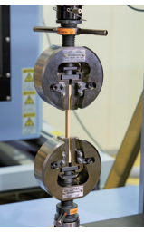
〔引張試験機〕 天然素材を使用したサステナブルプラスチックや熱可塑性エラストマーなど、高分子材料の材料強度を測定します。
