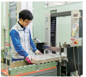
〔押抜きせん断試験装置〕 橋梁やトンネルの天井面からコンクリート片の崩落を防止する樹脂材料を開発しています。はく落したコンクリートを保持する耐荷性を試験します。
