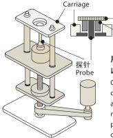
用探针接触胶带(面积20mm²) 以垂直方向分离时所需的力量
