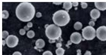
球状氧化铝 (电子显微镜照片)
