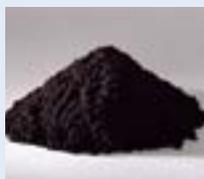
锂离子电池用导电助剂 (乙炔炭黑)
