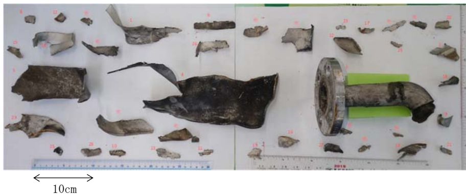
【図 8. 破裂した配管の破片】
