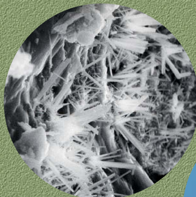
注入供試体の電子顕微鏡写真 (針状結晶:エトリンガイト水和物・2千倍)
