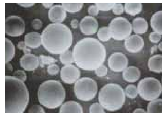
溶解シリカフィラー(球状タイプ)(下は電子顕微鏡写真)
