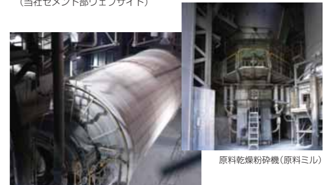
仕上げ粉砕機(セメントプラントボールミル)
