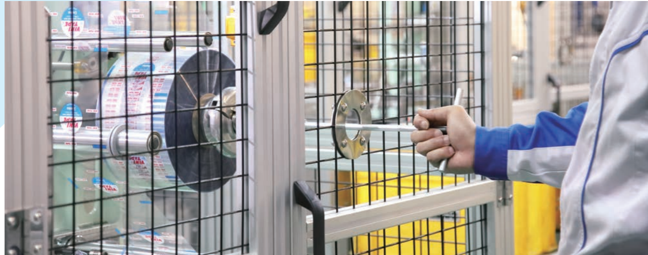
扶まれ・巻き込まれ防止のための安全柵設置例
