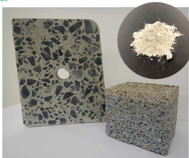
特殊混和材「LEAF®」 (CO 2 吸収コンクリート材料)
