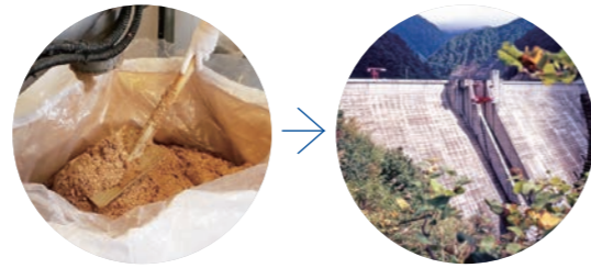
五泉事業所で排出される廃卵は、デンカ青海工場に運ばれ、セメントの原燃料として再利用される。
