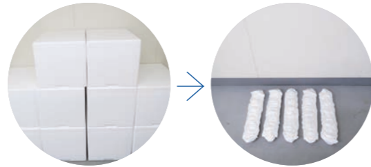
発泡スチロールを熔融機で減容化すると、容積が50分の1になる。
